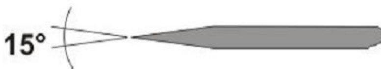
Рис. Форма заточки вольфрамового электрода
